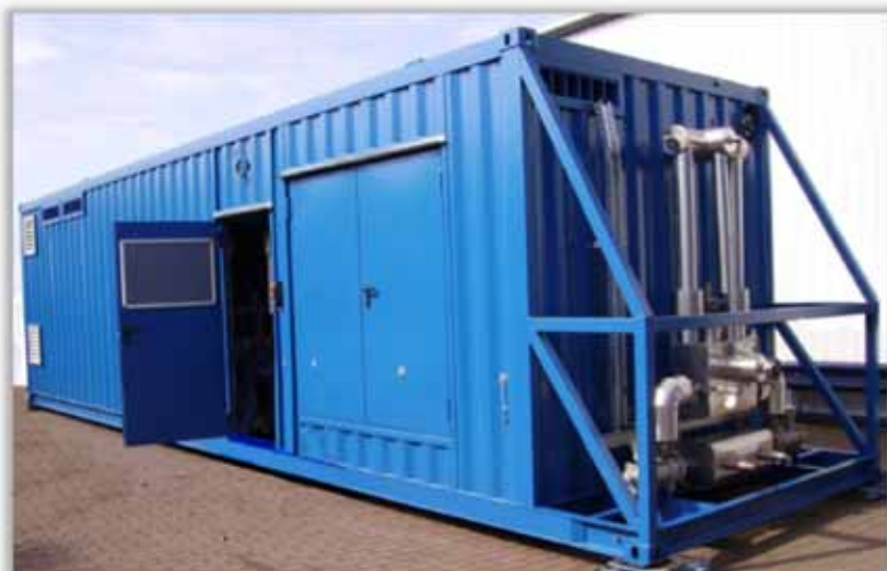
Versandfertige ex-geschützte CO 2 / Propen-Kaskadenkälteanlage in Sörup.
