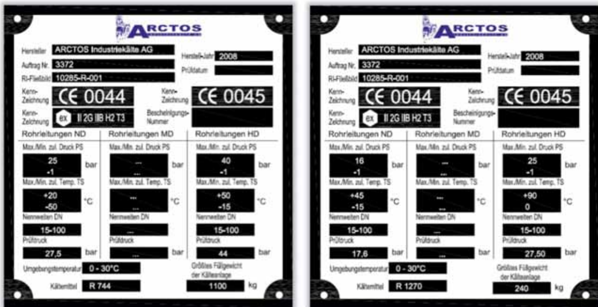
Typenschilder für die beiden Kältekreisläufe der CO 2 / Propen-Kaskadenkälteanlage.
